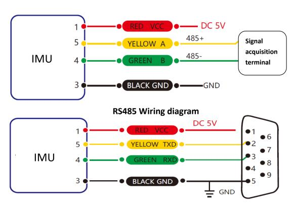
**RS232 Wiring diagram**
