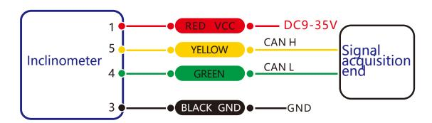
**CAN BUS wiring diagram**
